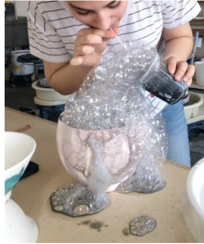
الاشكال توضح طريقة تنفيذ زجاج الفقاعات على سطح الاجسام الخزفية
