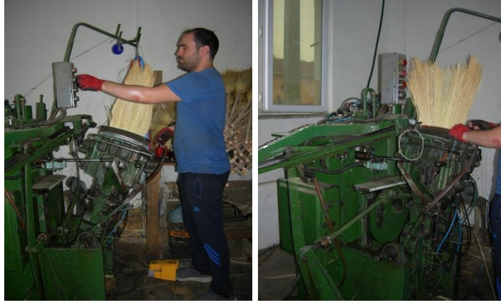
Fotoğraf 14-15. Süpürge dikiminin makine ile yapımı
