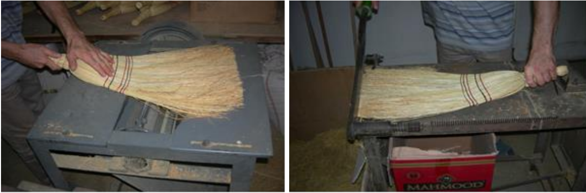
Fotoğraf 16-17. Dikimi yapılmış süpürgelerin düzeltilmesi
