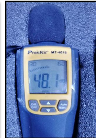
جهاز قياس منسوب الضغط الصوتي
